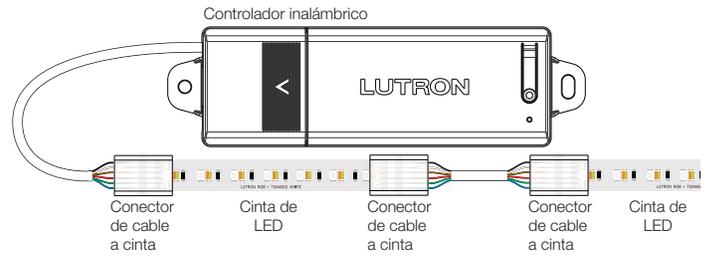
a. Mida y corte la longitud de cable necesaria para conectar las cintas en sus ubicaciones instaladas.
