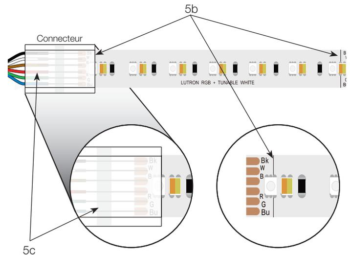
c. Insérez **les fils non dénudés** de calibre 0,50 mm<sup>2</sup> (22 AWG) fournis par Lutron dans les orifices de fil du connecteur en veillant à aligner la couleur du fil au canal approprié sur le ruban.
