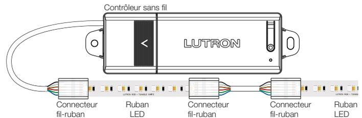
a. Mesurez et coupez la longueur de câble nécessaire pour connecter les rubans à leurs emplacements d'installation.
