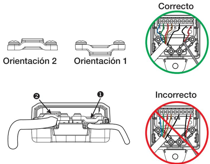
5. Instale la cubierta del terminal.
