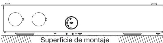
3. Abra las tapas ciegas necesarias para pasar los cables hacia el compartimiento del cableado.
