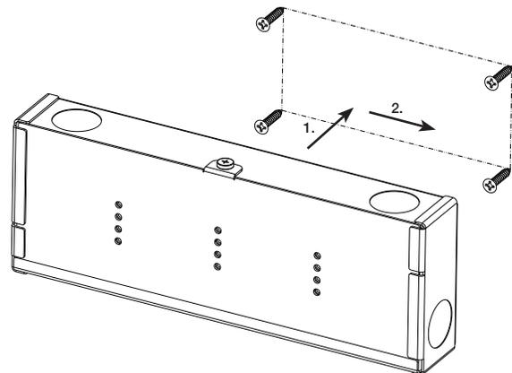
3. Ouvrez les entrées à perforer nécessaires pour passer les fils dans le compartiment de câblage.
