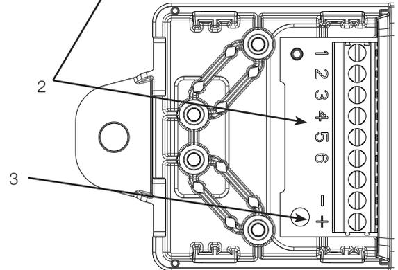
4. Installez le réducteur de tension et serrez les vis.
