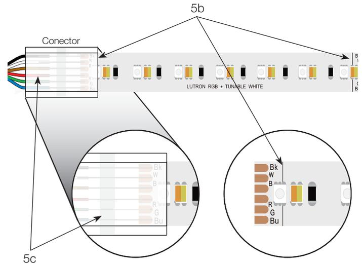
c. Inserte cables de 0,50 mm<sup>2</sup> (22 AWG) **sin pelar**, suministrados por Lutron, en los orificios para cables del conector, asegurándose de alinear el color de los cables con el canal adecuado de la cinta.
