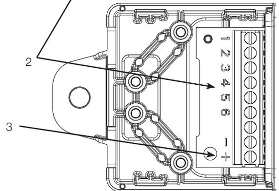
4. Instale el aliviador de tensiones y apriete los tornillos.
