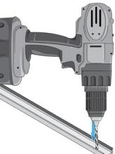
Fixez le canal à la surface de montage à l'aide d'un tournevis.
